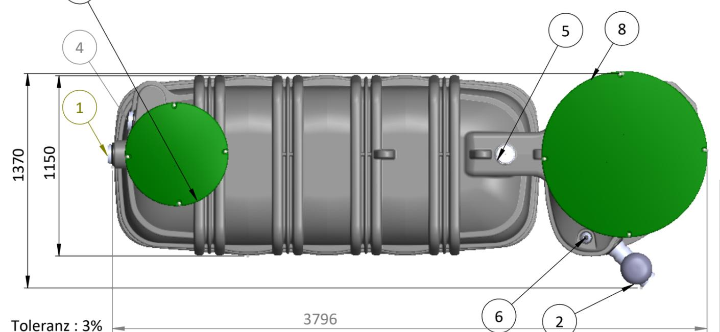
Diese Kleinkläranlage ist für den Einbau bei hohem Grundwasserstand geeignet.
